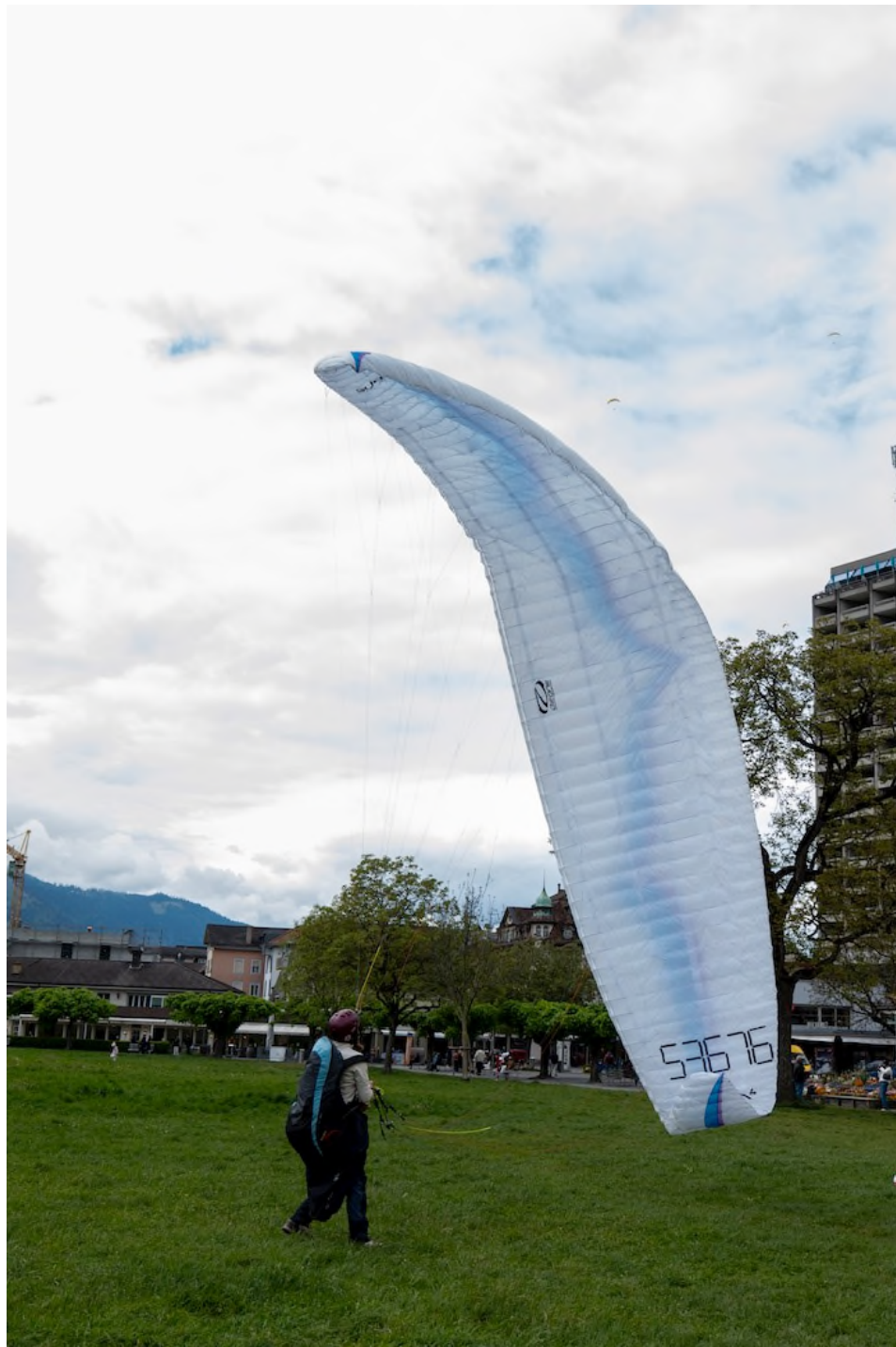
Als sogenannter C-Schirm fliegt Sarah Zimmermann «Mittelklasse». Der Schirm ist durchschnittlich in der Geschwindigkeit und hat mehr Sicherheitsaspekte als ein Wettkampfschirm.
